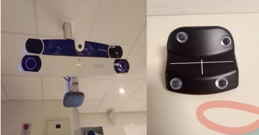
Truebeam con sistema RPM de Varían
